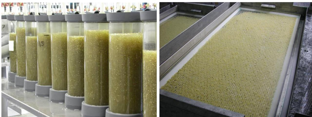
Relativamente alle strutture destinate allo svezzamento e al primo accrescimento degli avannotti, si tratta di vasche che possono essere rettangolari, quadrate o circolari, con una propria immissione d'acqua regolabile tramite valvola o rubinetto, e uno scarico. Per la distribuzione del cibo è possibile dotarle di mangiatori automatici a nastro che possono garantire una costante distribuzione del cibo nelle 12 o nelle 24 ore a seconda del modello.
