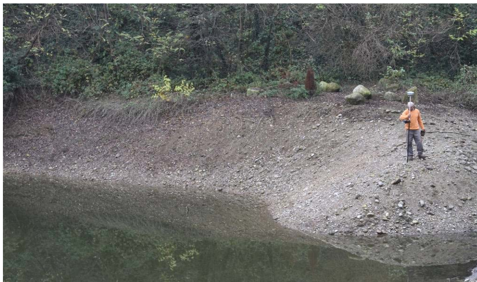
Figura 55. rilievo sponde del lago mediante gps (Novembre 2015)
