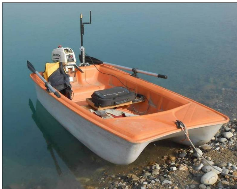
Figura 63. Barca a fondo piatto attrezzata per il rilievo
