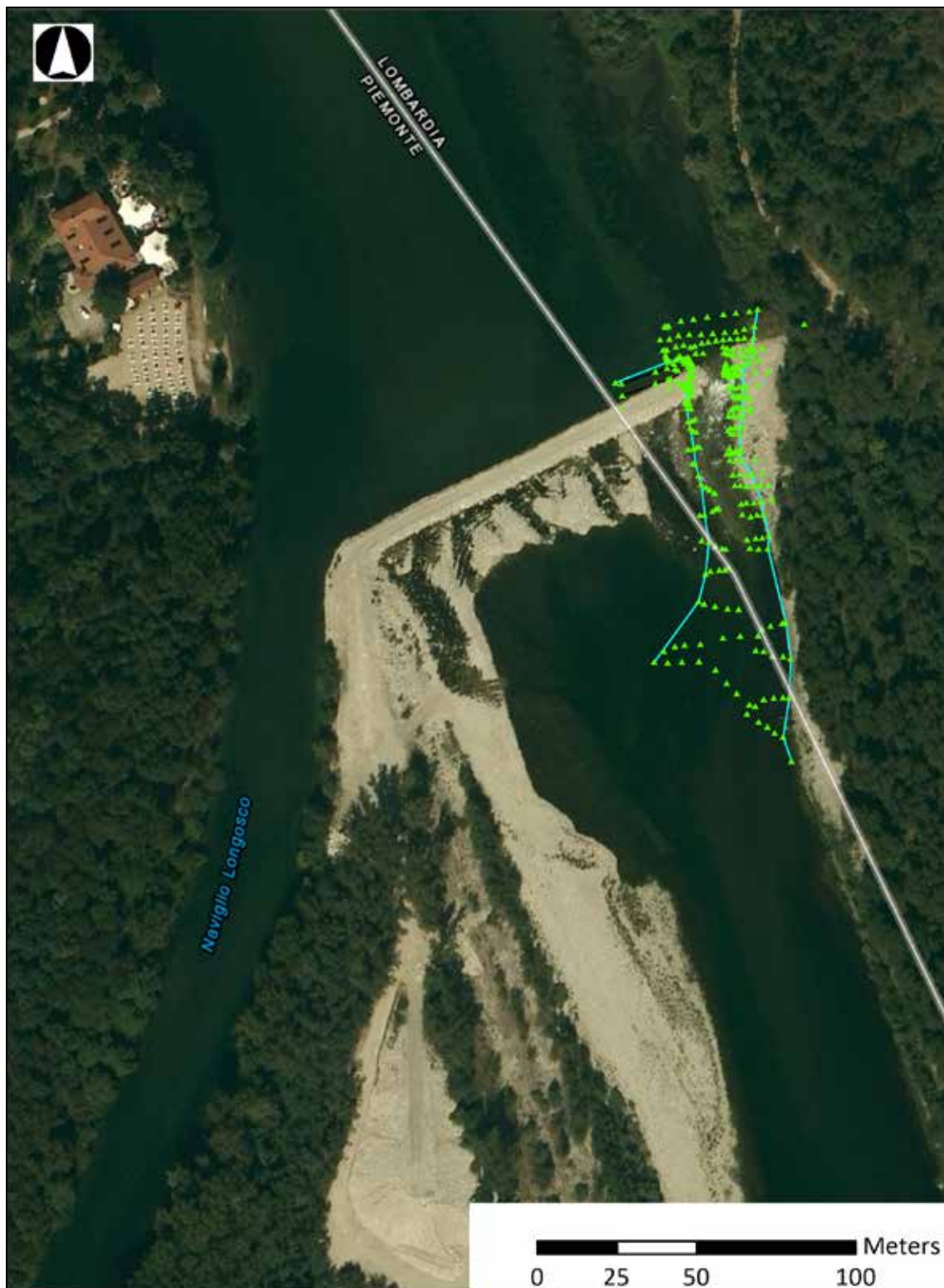
Figura 2.10: filarola a servizio del Naviglio Langosco - punti rilevati
