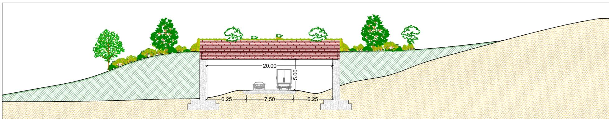
Foto n.1 - Inquadramento dell'area in cui si inserisce l'ecodotto in progetto
