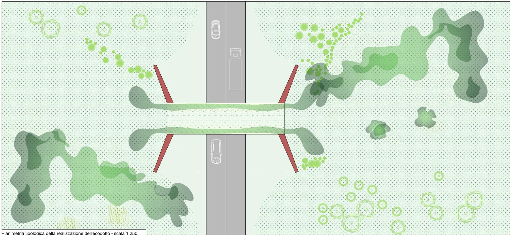
Planimetria tipologica della realizzazione dell'ecodotto - scala 1:250
