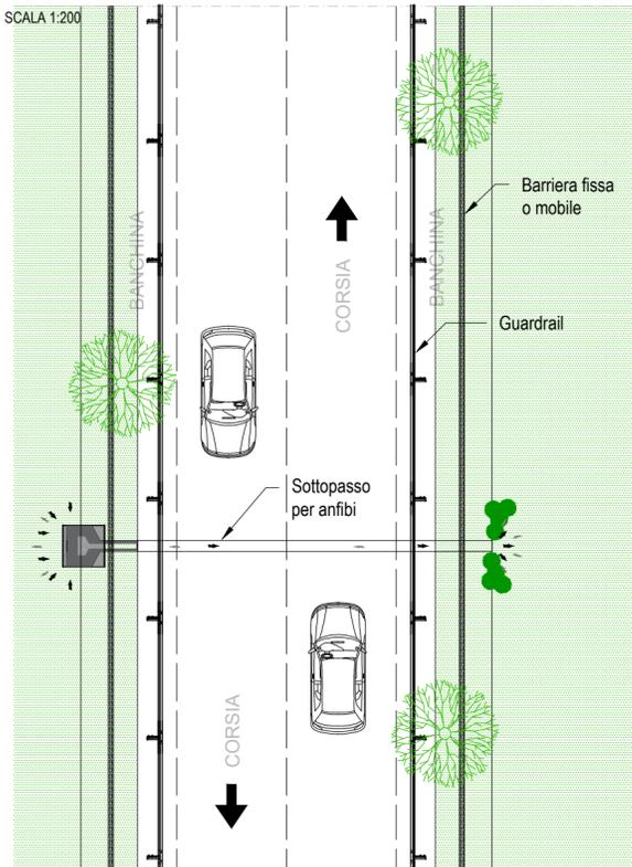
**PLANIMETRIA DI DETTAGLIO DEL SOTTOPASSO**
