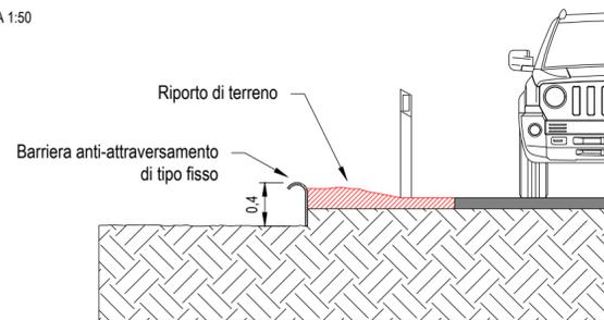
**SEZIONE TRASVERSALE SOTTOPASSO PER ANFIBI**
