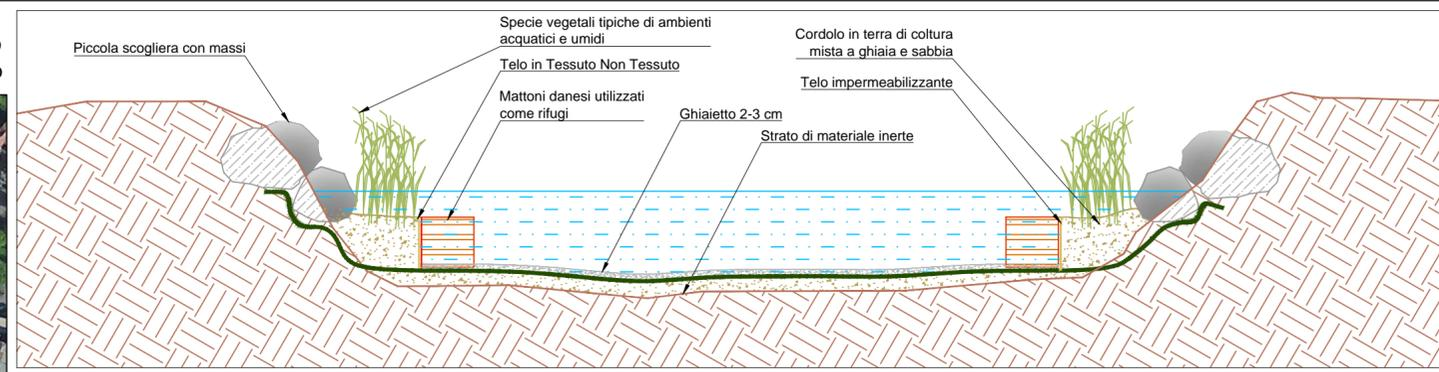
Sezione tipologica di realizzazione di uno stagno per gamberi - scala 1:500
