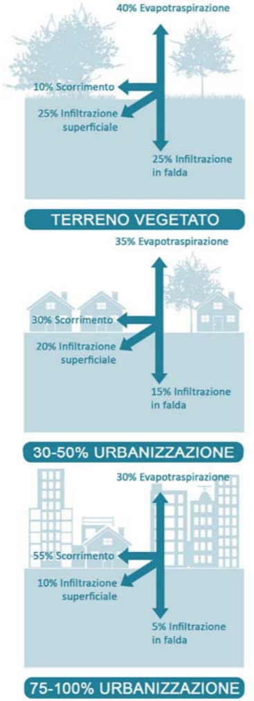
d Schemi che evidenziano come l'aumento dell'impermeabilizzazione comporti una riduzione progressiva dell'infiltrazione e un aumento del run-off.
