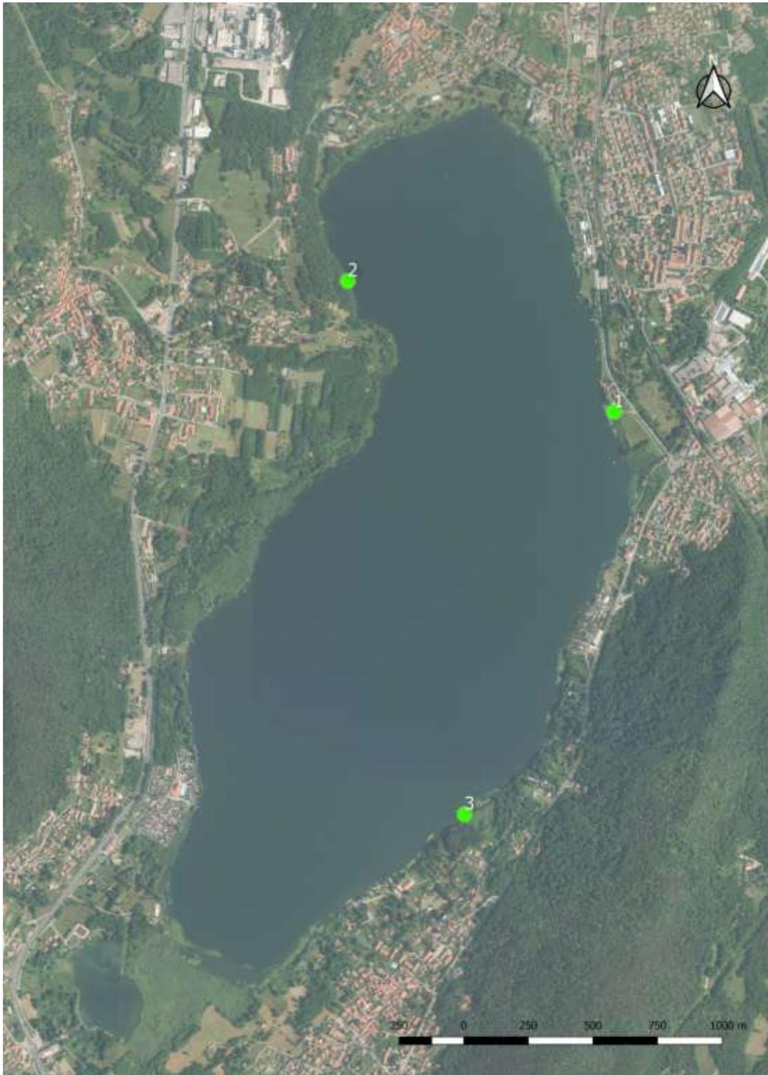
Tutto il rilievo effettuato fa riferimento al livello del lago che al momento delle misurazioni era pari a 52 cm rispetto all'idrometro installato presso la darsena centrale dell'ex piscicoltura di Varano Borghi.
