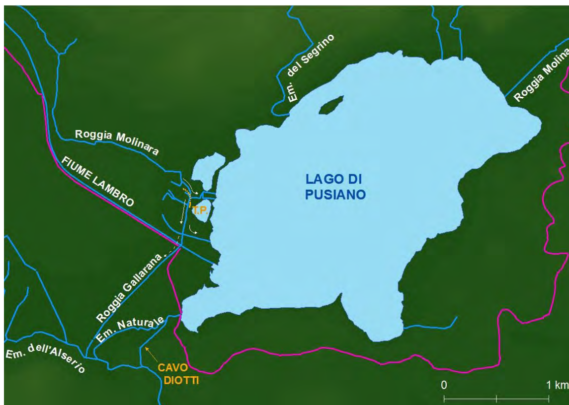
Figura 1.13. Idrografia attuale nei pressi del Lago di Pusiano: nella zona della Roggia Molinara vengono indicate le direzioni dei flussi e il “troppo pieno” (T.P., ovvero la soglia che separa le acque della Roggia Molinara con quelle della Roggia Gallarana la quale bypassa poi il Fiume Lambro: Molinara e Gallarana si ricongiungono durante alcuni eventi di piena). Il termine “Cavo Diotti” indica il canale artificiale dotato di paratoie per la regolazione del livello del lago.
