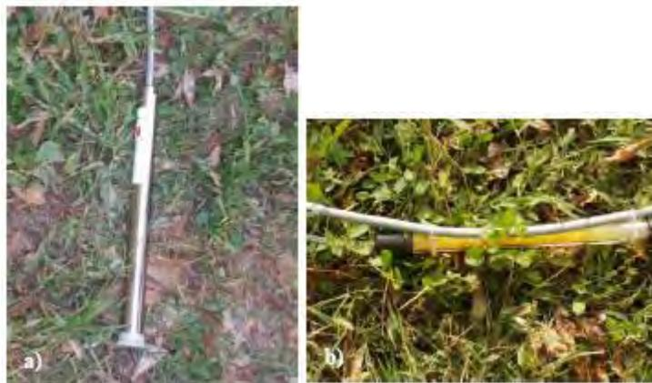
*Figure 2.1.9. L'idrometro DipperIII composto da un contenitore cilindrico (a) collegato tramite uno spinotto ad un tubicino contenente resine.*
