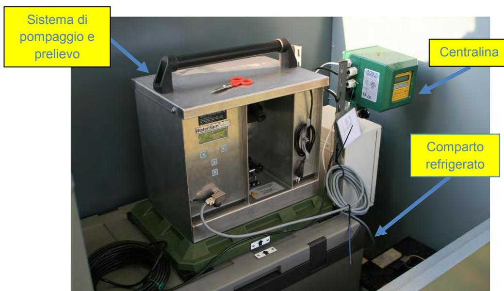
*Figura 2.1.6. Dettaglio dell'autocampionatore WaterSam.*
