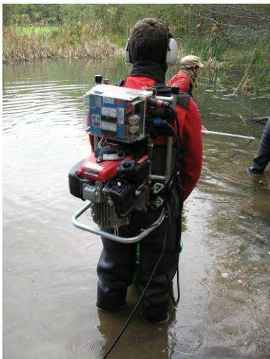
Figura 18 – Elettrostorditore a spalla
