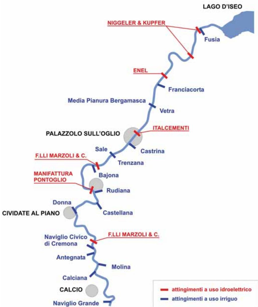
Fig. 1 - Schema delle derivazioni a uso idroelettrico e irriguo
