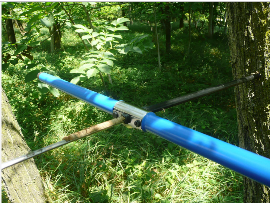
Foto 15: campionamento su Robinia con sonda incrementale per determinazione età e sviluppo degli anelli di crescita.
