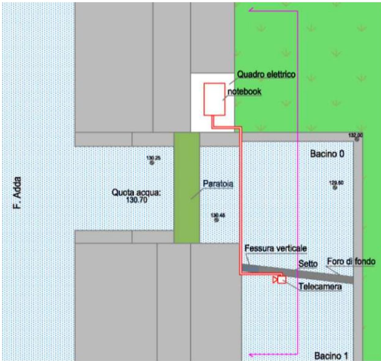
Figura 22. Posizionamento del sistema di monitoraggio subacqueo - PROSPETTO FRONTALE - SCALA 1 : 50
