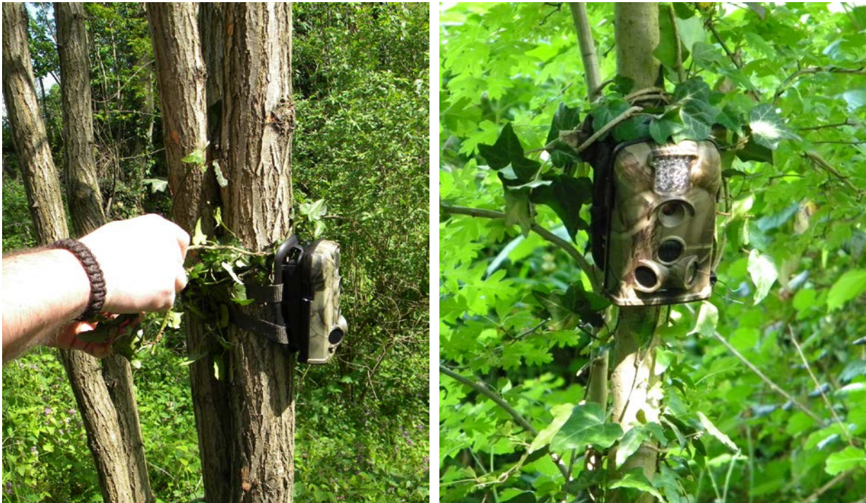
Figura 1 - Due immagini di fototrappole. Nella parte anteriore si possono osservare i sensori di movimento in basso e nella parte alta gli illuminatori IR.
