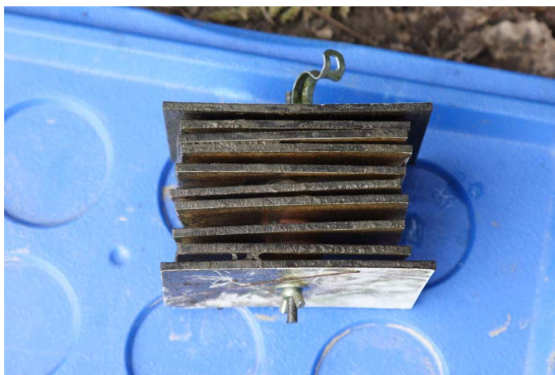
Figura 11 – Esempio di supporto artificiale realizzato per il campionamento dei macroinvertebrati
